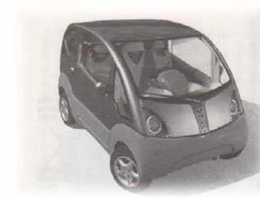
MDI社製 三人乗り 圧縮空気エンジン車 「MiniCAT」
