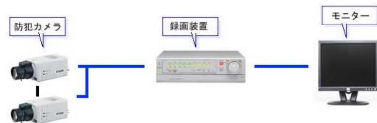
SDカードやHDDはレコーダー本体にありますが消耗品です。標準寿命は1~2万時間ありますが一年間は8760時間、使用条件では三年前後でHDDの交換になります。更に定格時間は周囲温度25度が前提です。そのため冷却ファンがついていますがこれも消耗品です。SDカードのみの交換ですと手軽に交換できますがHDDの場合、レコーダー本体を開けての交換作業やHDDのフォーマット、場合によってはアプリケーションの再インストールや再設定が必要となります。通常、メーカーに依頼することになります。10万円前後かかる場合もあります。
